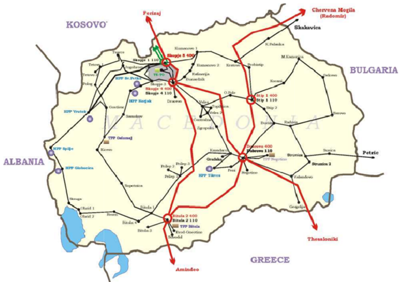
Figura 1; Sistemi elektro-transmetues i Maqedonisë
